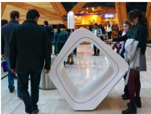
図 38 裏表の角度と高さが異なるので車いすでも使える
